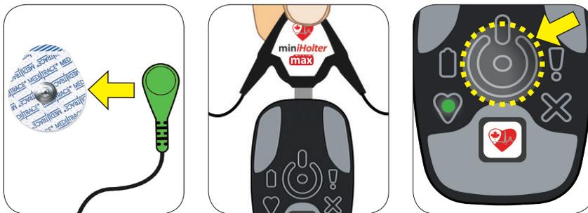
1. Connectez le câble et le jeu de câbles aux électrodes (FIG 1).
